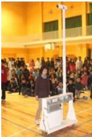
新型自動ドア「インテリジェントecoドアシステム」は72のセンサーを搭載。通り抜けようと正面から近づいた時にだけドアが開く。無駄な開閉が減らせるため省エネ効果が高い
