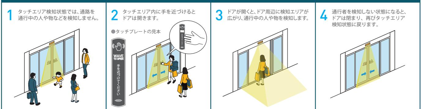
▲ 照射した近赤外線の反射による、疑似的な非接触タッチセンサー機能となります。そのため、機械式タッチスイッチと異なり、タッチプレート周辺以外でも検出することがあります。
