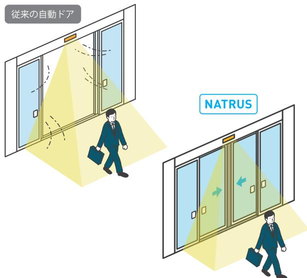
ドア開閉速度・開放時間などの多彩で細かい作動設定が可能のため、設置環境に最適なドア作動で快適な通行を実現します。
