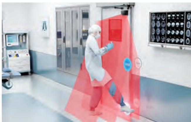
バーチャルオープニングボタン (非接触タッチ機能) を検知範囲内において片側最大2箇所に設定できます。
