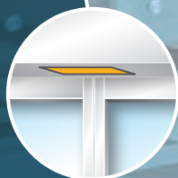
MS-(N)02 無目内蔵タイプ 無目にセンサー本体を埋め込める形で取付けるタイプ。 取付部がフラットとなり、美観を損ないません。
