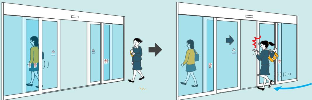
自動ドアが閉じ始めている時に、斜めから自動ドアに進入しようとしたことで、ドアが反転して開く前に接触する。
