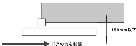
固定されたFix (袖壁) とドアの前面の距離が 150mm 以下であり、ドアの力が JIS A 4722 に定める基準以下であること。
