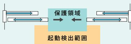
ドア作動前にセンサーの安全機能が正常に働いているかをドア装置自身で毎回テストします。ドアが開閉する度に安全点検をするので、いつでも安心してご利用いただけます。
