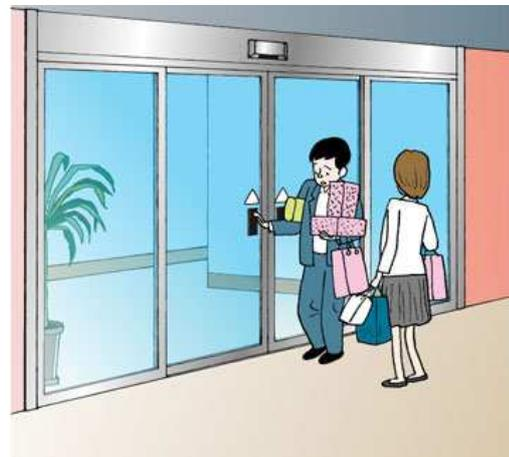
『インテリジェントecoドアシステム』は人がドアを通過した後の不要開放時間を削減します。
